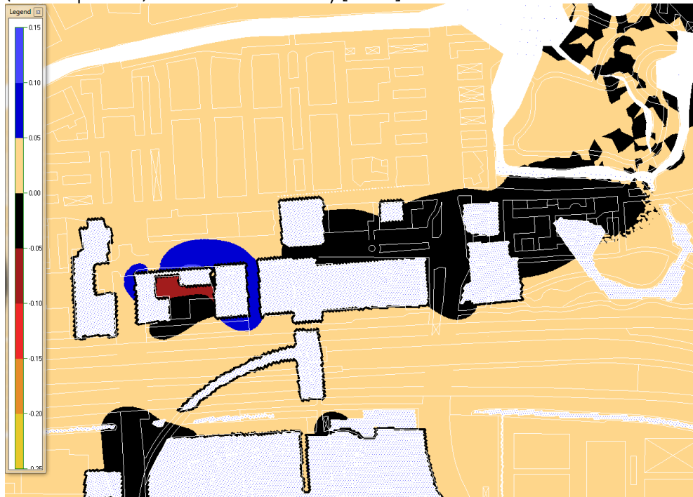
Figuur 2: Verschil grondwaterstand (in m) tussen de huidige situatie en de tijdelijke situatie met ontwikkelingen van Vijfhoek, CRI, Atrium, NPL en WTC. Witte kaders met zwarte omkadering zijn ondergrondse constructies en witte kaders zonder omkadering is oppervlaktewater.
