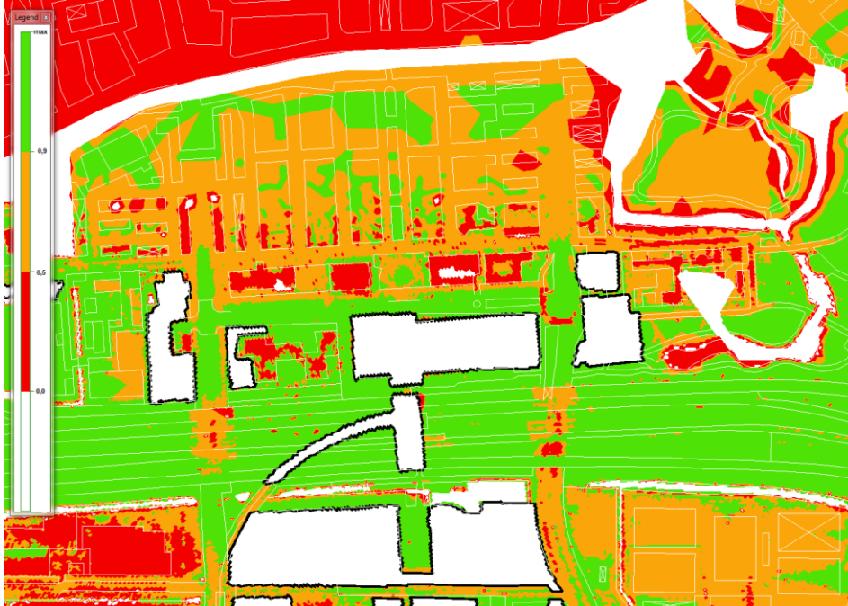
Figuur 2-3: Berekende ontwatering in de huidige situatie. De ontwatering wordt berekend op basis van de Algemene Hoogtekaart Nederland (AHN2) [bron 10 ]. Aangezien een deel van de gebouwen in de AHN2 een maaiveldhoogte van NAP 0,0 m hebben, is de ontwatering ter plaatse van deze bebouwing foutief, dit veroorzaakt de rode vlekken bij de bebouwing. Witte kaders met zwarte omkadering zijn ondergrondse constructies en witte kaders zonder omkadering is oppervlaktewater.
