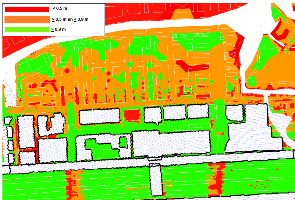
Figuur 4-3: Berekende ontwatering in de toekomstige situatie (op basis van de GHG) met ondertunneling ringweg A10-Zuid (Zuidasdok) en alle ontwikkelingen in deelgebied Strawinsky (waaronder drainerende voorziening in de Prinses Irenestraat) [m]. De ontwatering wordt berekend op basis van de Algemene Hoogtekaart Nederland (AHN2) [bron 10 Fout! Bladwijzer niet gedefinieerd. ]. Aangezien gebouwen in de AHN2 een maaiveldhoogte van NAP 0,0 m hebben, is de ontwatering ter plaatse van bebouwing foutief, dit veroorzaakt de rode vlekken bij de bebouwing. Witte kaders met rode omkadering zijn ondergrondse constructies en witte kaders zonder omkadering is oppervlaktewater.
