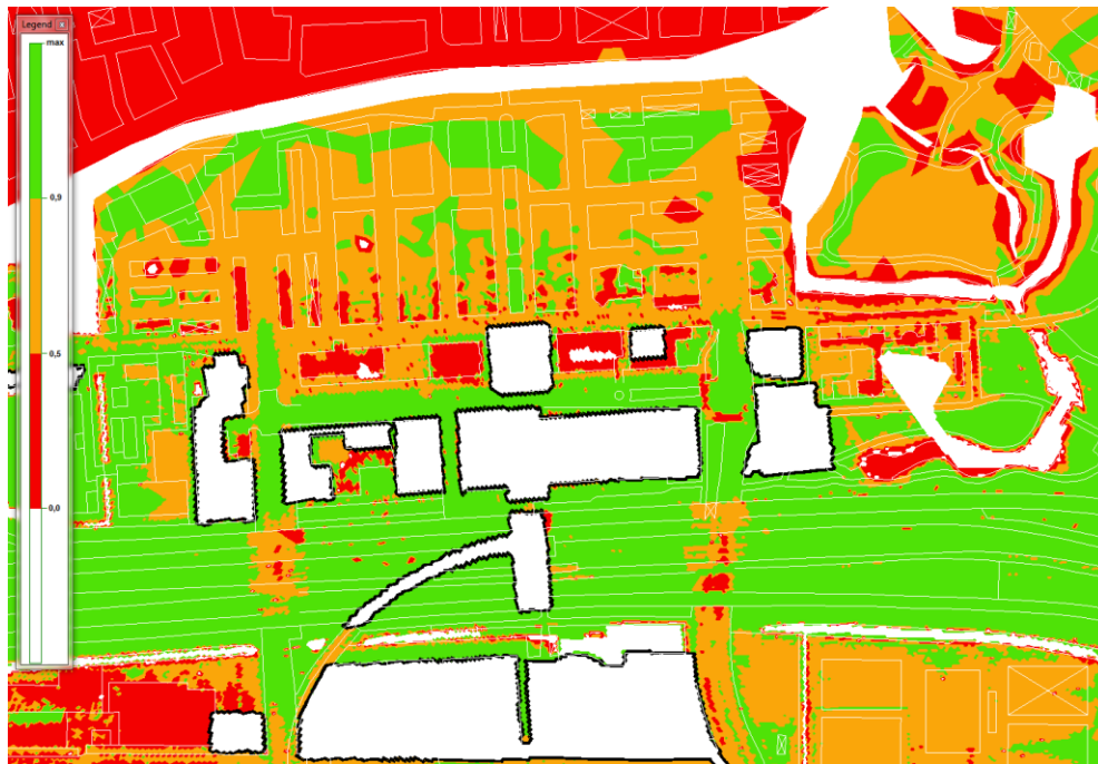
Figuur 3: Berekende ontwatering in de toekomstige situatie met ontwikkelingen van CRI, Atrium, NPL en WTC. De drainerende voorziening in de Irenestraat en het Zuidasdok zijn nog niet aangelegd. De ontwatering wordt berekend op basis van de Algemene Hoogtekaart Nederland (AHN2) [bron v ]. Aangezien een deel van de gebouwen in de AHN2 een maaiveldhoogte van NAP 0,0 m hebben, is de ontwatering ter plaatse van bebouwing foutief, dit veroorzaakt de rode vlekken bij de bebouwing. Witte kaders met zwarte omkadering zijn ondergrondse constructies en witte kaders zonder omkadering is oppervlaktewater.
