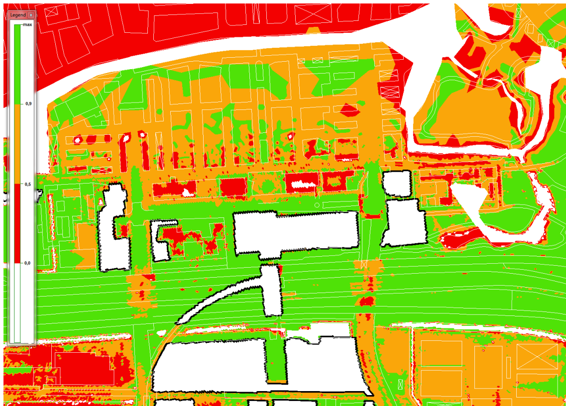
Figuur 1: Berekende ontwatering in de huidige situatie. De ontwatering wordt berekend op basis van de Algemene Hoogtekaart Nederland (AHN2) [bron v ]. Aangezien een deel van de gebouwen in de AHN2 een maaiveldhoogte van NAP 0,0 m hebben, is de ontwatering ter plaatse van deze bebouwing foutief, dit veroorzaakt de rode vlekken bij de bebouwing. Witte kaders met zwarte omkadering zijn ondergrondse constructies en witte kaders zonder omkadering is oppervlaktewater.
